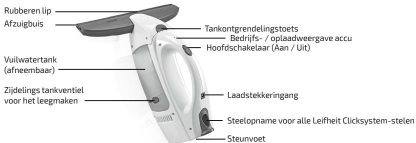
Afbeelding 2: Vensterzuiger bedieningselementen
